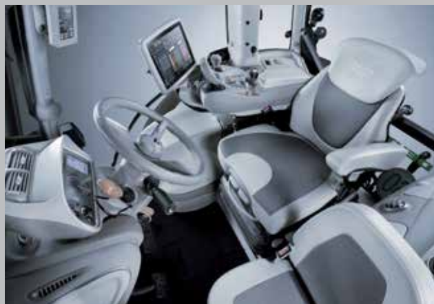
Komfortowa kabina MaxiVision 2 wyposażona w iMonitor 2.0, pozwala na zautomatyzowanie szeregu funkcji co podnosi komfort pracy operatora.
