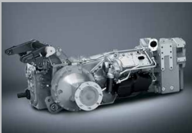
Wydajna bezstopniowa skrzynia biegów zapewnia płynną zmianę prędkości jazdy od 0 do maksymalnie 40 km/h oraz trzy tryby pracy napędu.
