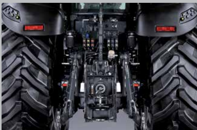
Podnośnik tylny EHR o udźwigu 12000 kg, hydraulika z pompą Load-Sensing 210 l/min, trzy prędkości tylnego wałka odbioru mocy.
