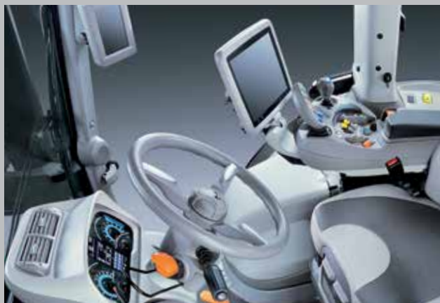
Kabina MaxiVision 2 z podłokietnikiem wielofunkcyjnym oraz iMonitorem 8" lub 12". Najwyższy komfort i ergonomia sterowania funkcjami ciągnika.
