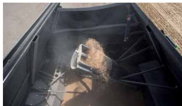
Zbiornik o pojemności 9500 litrów z nadstawką.
