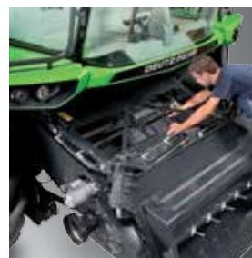
Zdemontowane osłony przenośnika pochylego, wygodna kontrola przenośnika łańcuchowo-listwowego.
