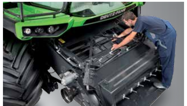
Duże, otwierane pokrywy zapewniają dobry dostęp do wnętrza przenośnika pochyłego, co ułatwia obsługę.
