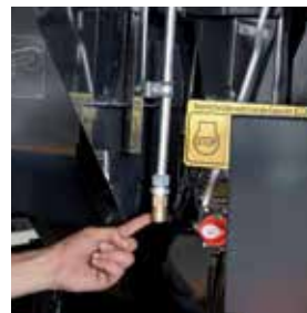
Kompresor umieszczony za wentylatorem. Trzy wyjścia z każdej strony kombajnu.
