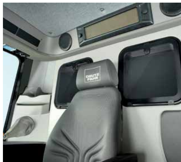
Podwójne okna inspekcyjne zbiornika w kabinie.
