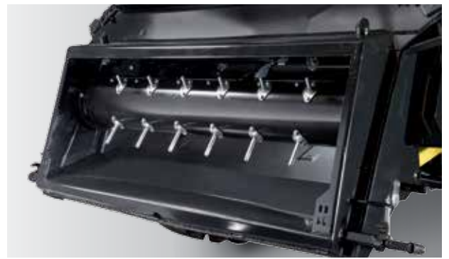
Nowy przenośnik pochyły "Extra Feeding" z dodatkowym bębniem podającym masę do przenośnika pochyłego.
